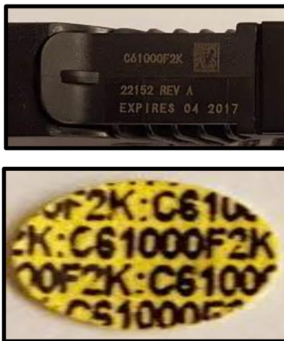
8.ábra: TASER X2 kilövőfej azonosító címke (AFID) 30
