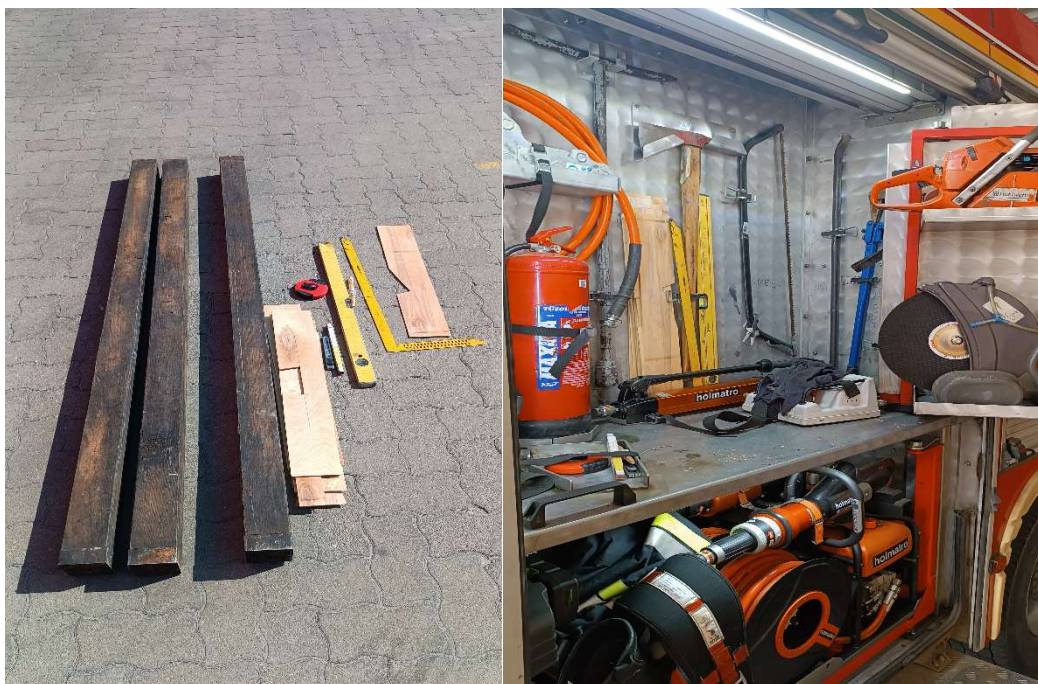
20. ábra Ácsolathoz használt szerszámok és málhatérbe helyezése
