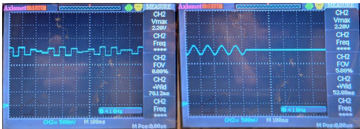
19. ábra Kiadott analóg 10 Hz-es szinusz jel való időbeli értéke alacsony, 9600 -as (bal) és magas, 115 200-as (jobb) baud értékek esetén egy oszcilloszkópon mérve.
