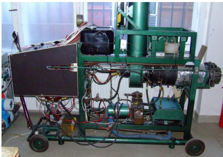
6. ábra: TKT-1 egyáramú, változtatható fűvócsővel rendelkező gázturbinás sugárhajtómű [10].
