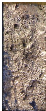
Ábra 2-23: TP6 minta szakadási felülete Specimen 1.5
