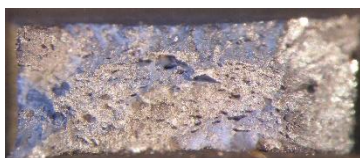
Ábra 2-19: DP minta szakadási felülete Specimen 1.2
