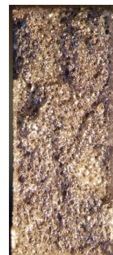
Ábra 2-22: TP10 minta szakadási felülete Specimen 1.17
