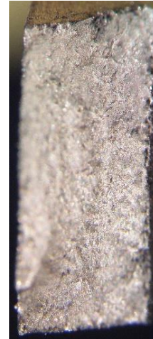
Ábra 2-33: TPXY minta szakadási felülete Specimen 1.27
