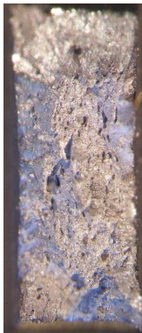
Ábra 2-32: DP minta szakadási felülete Specimen 1.2
