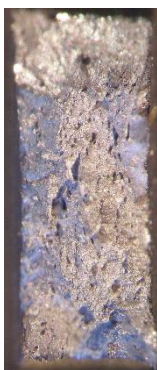
Ábra 2-24: DP minta szakadási felülete Specimen 1.2
