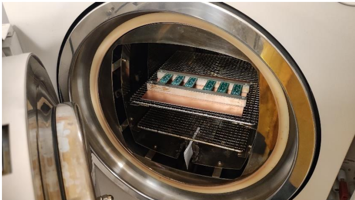
16.2.1. ábra: Áramkörök a HAST kamrában
