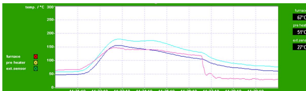
11.5.2. ábra: A 3. hőprofilhoz tartozó valós hőmérséklet diagramm.
