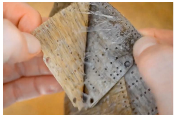
4.3.1. – 4.3.2. ábra: JIVA Soluboard®, melyről vízbe helyezve könnyen leszedhetők az alkatrészek, valamint megindul a rostokból készült hordozó delaminációja. [PIC_1][PIC_2]
