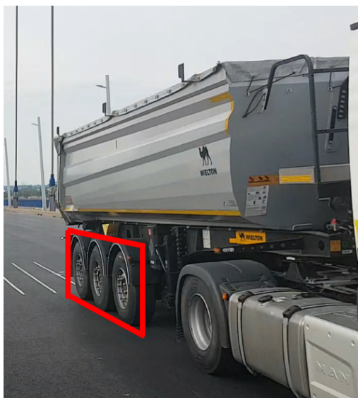
3.6. ábra. Az ábrán egy nyerges vontató látható. A rajta elhelyezkedő tridem tengelycsoport pirossal bekeretezve látható.
