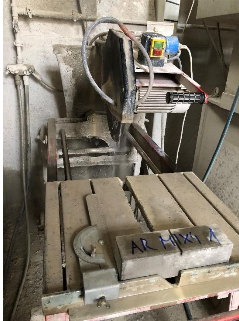
7.4. ábra Betonvágó és bevágott próbatest
