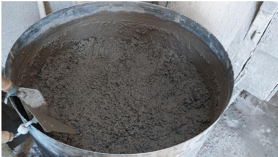
4.1. ábra Kényszerkeverő, benne friss betonnal
