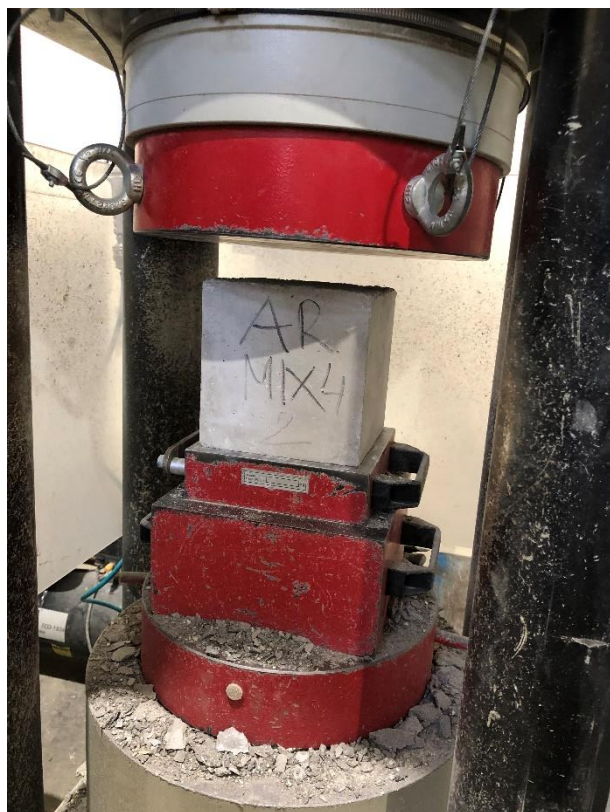
5.1. ábra Hidraulikus nyomógép, vizsgálatra előkészítve
