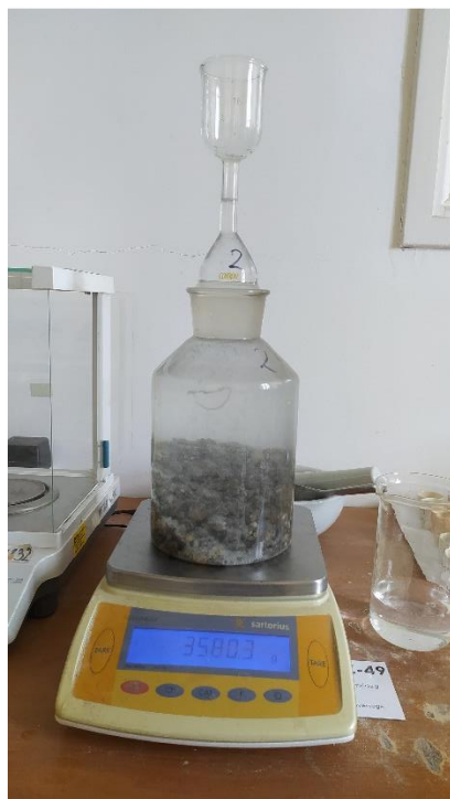
6.4. ábra Piknométer mérés közben
