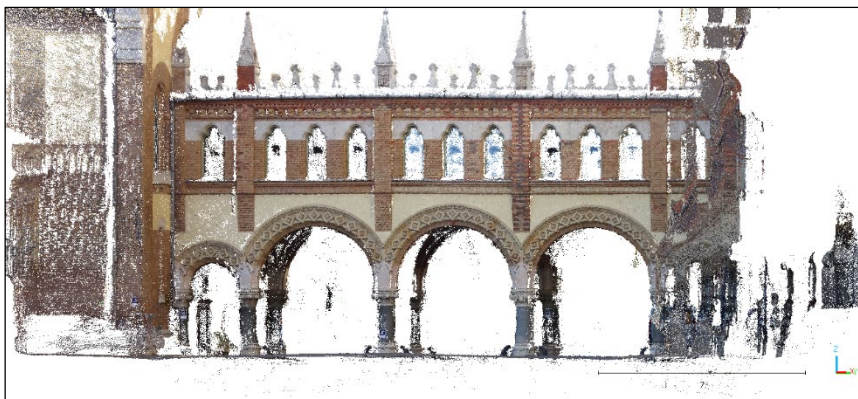
26. ábra Meshroom, középtávról készült képekből előállított pontfelhő
