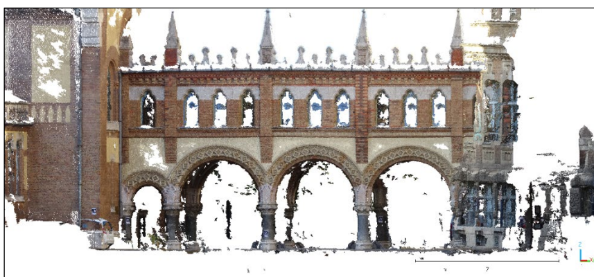
18. ábra WebODM, középtávról készült képekből előállított pontfelhő
