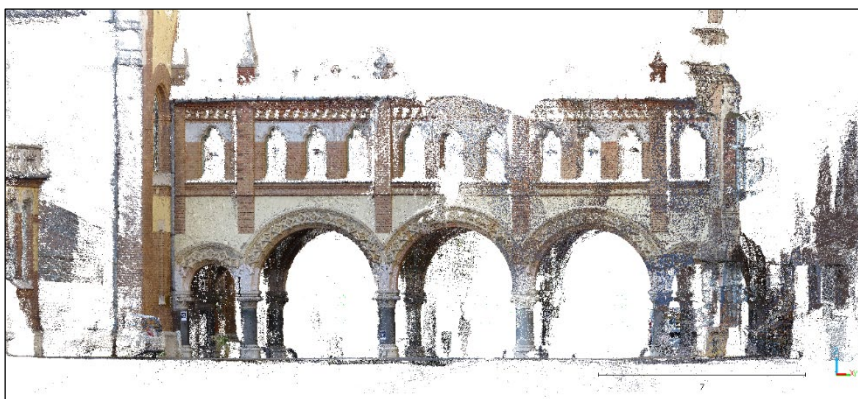
27. ábra Meshroom, közelről készült képekből előállított pontfelhő
