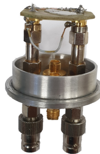
(b) Nagyfrekvenciás mérésekre is használt mintatartó, ami SMA-BNC átalakítóval felszerelve kapcsolható az áram-feszültség mérőrendszerbe. A földelt ér folytonosságát biztosító fehér vezeték jól látható a NYÁK lap alatt.
