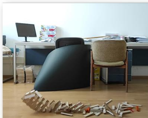
Szétszúszási szakasz. Törmelékmozgás az eredeti dőlés és az azzal ellentétes irányba.
