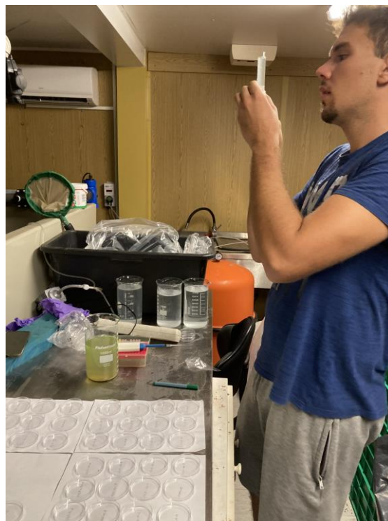
10. ábra 10 ml minta kimérése fecskendő segítségével (forrás: Petényi Róbert)
