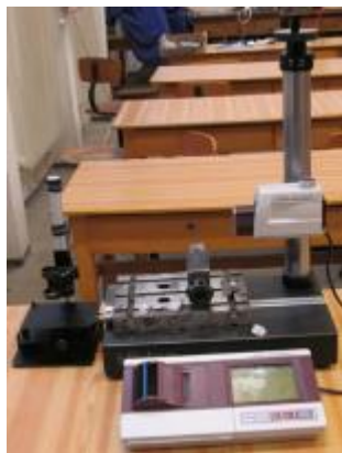
3.10. ábra Mitutoyo Surfes SJ-401 típusú felületi érdességmérő [30]
