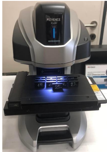
3.9. ábra A KEYENCE VR-5000 Series típusú topográfus mikroszkóp
