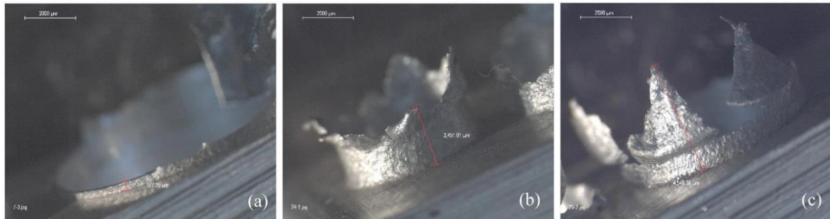
2.8. ábra Különböző sorjátípusok furatoknál: (a) körkörös-, (b) korona- és az (c) átmeneti sorja [29]
