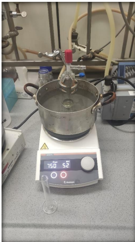
8. ábra: A nifedipin (4) szakaszos előállítása bombacsőben
