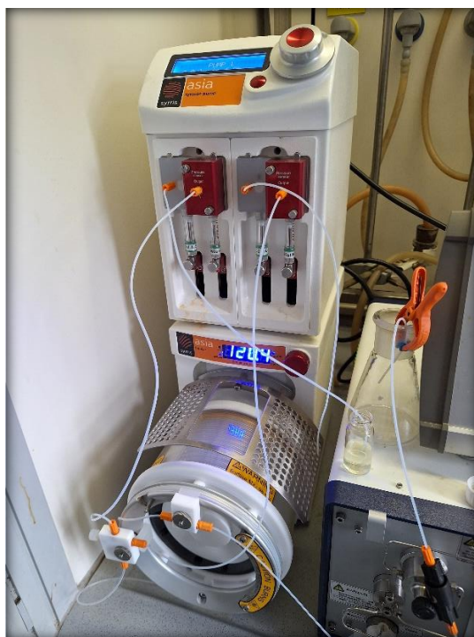
9. ábra: A nifedipin előállítása Asia ® csőreaktorban
