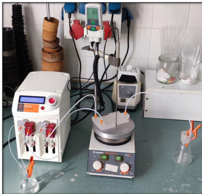
18. ábra: A 130x81 mm-es PP reaktor hűesztje laboratóriumi mágneses keverőlapon
