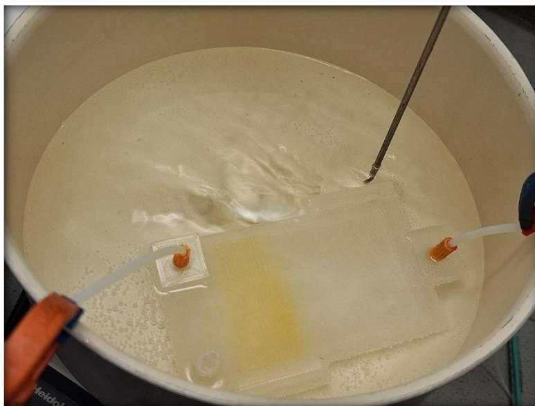
24. ábra: A nifedipin szintézise 3D nyomtatott PP reaktorban 80 °C-os vízfürdőben
