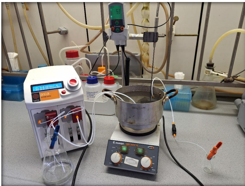
22. ábra: A PA6-CF reaktor fűtése szilikonolaj-fürdőben
