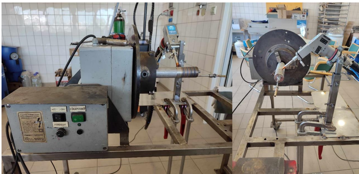
13-14. ábra: A forgató berendezés és a befogó készülék fényképe
