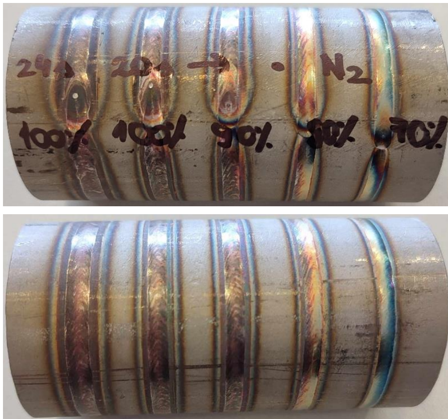
21-22. ábra: 40 cm/min haladási sebesség (első varrat kivétel – 33 cm/min) mellett készített varratok fényképe, balról jobbra 100%-tól 70%-ig 10%-onként csökkentve a leadott lézerteljesítményt
