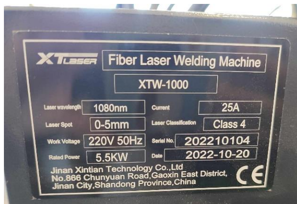
8-9. ábra: A kísérletekhez használt lézersugaras hegesztőgép és annak adattáblája
