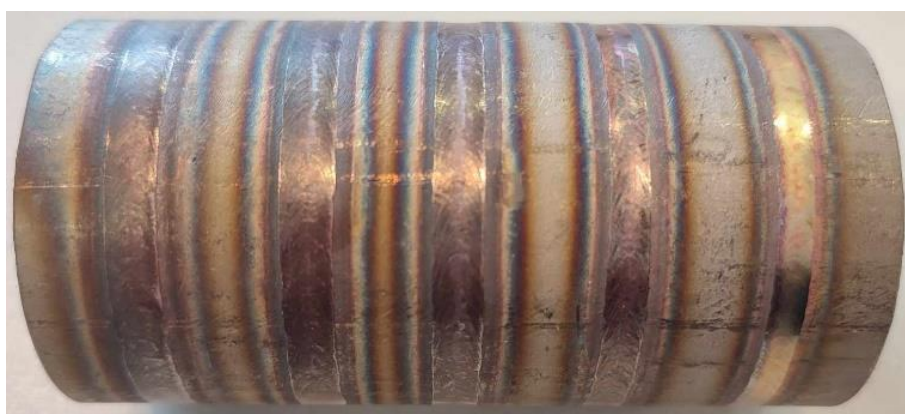
17-18. ábra: 24 cm/min haladási sebesség mellett készített varratok fényképe, balról jobbra 100%-tól 60%-ig 10%-onként csökkentve a leadott lézerteljesítményt
