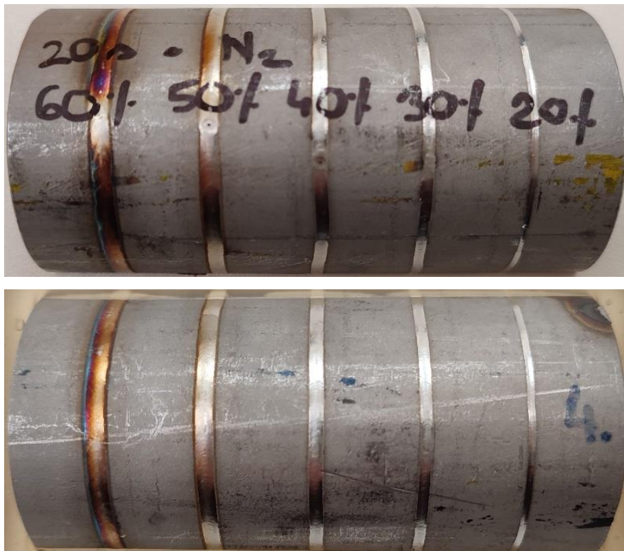
23-24. ábra: 40 cm/min haladási sebesség mellett készített varratok fényképe, balról jobbra 60%-tól 20%-ig 10%-onként csökkentve a leadott lézerteljesítményt
