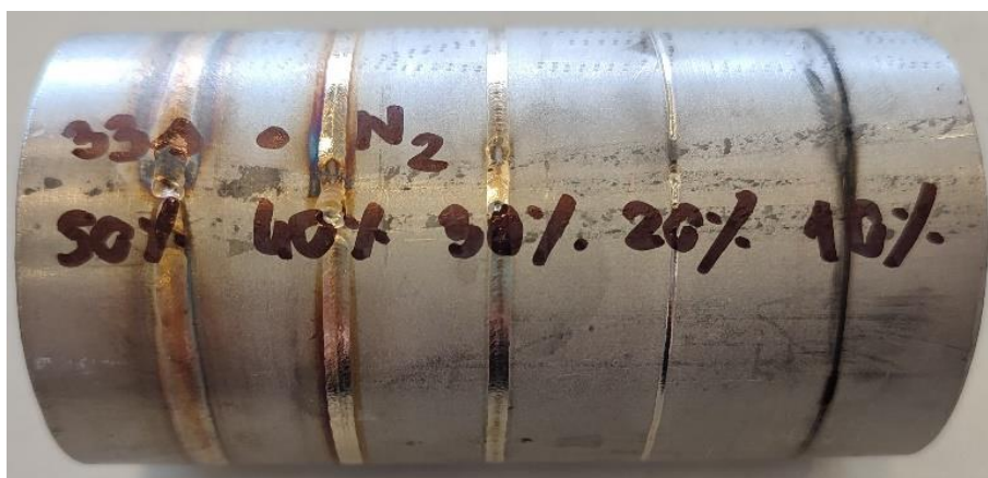
17-18. ábra: 24 cm/min haladási sebesség mellett készített varratok fényképe, balról jobbra 100%-tól 60%-ig 10%-onként csökkentve a leadott lézerteljesítményt
