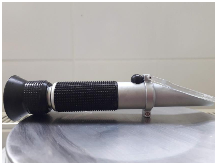
10. ábra: Kolosztrum refraktométer Forrás: Saját felvétel, (2023)
