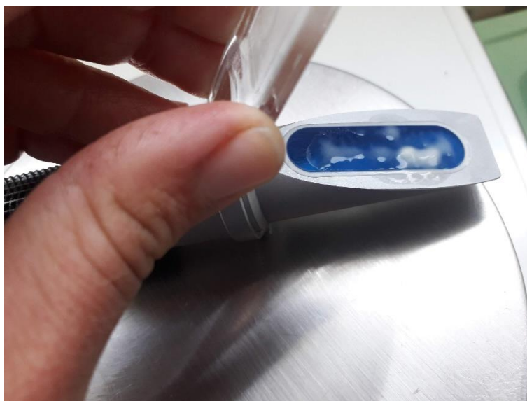
11. ábra: A minta vizsgálata kolosztrum refraktométerrel Forrás: Saját felvétel (2023)
