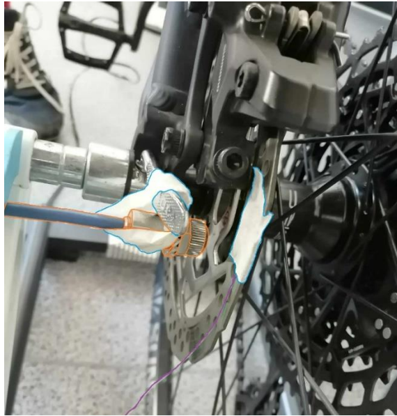
19. Ábra: Feketeségi fok meghatározásának mérési elrendezése Kép forrása: spot hőkamera narancssal; hőmérő vezetéke lilával
