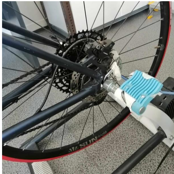
14. Ábra: A mérési elrendezés fényképe (görgő; slick külső; tárcsafék)
