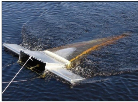
4. ábra: Manta háló vízminta-gyűjtés közben [24].
