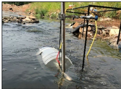
3. ábra: Szita vízminta-gyűjtés közben [22].
