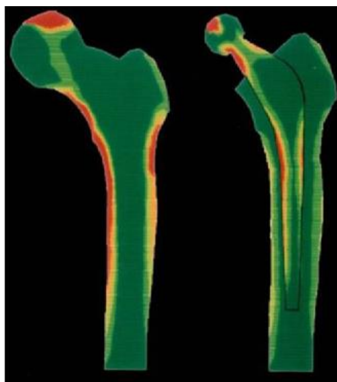
9. ábra Femur proximális vége protézis nélkül (bal) és protézissel (jobb) készült SED (Strain Energy Density) felvétel [17]
