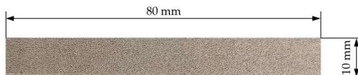
9. ábra A fémhab lemezből kimunkált darabok geometriája
