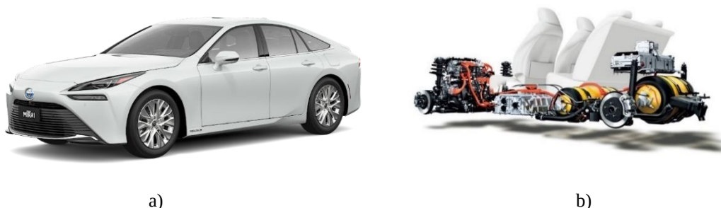
2. ábra A második generációs hidrogénhajtású Toyota Mirai (a) és az autó hajtásrendszere (b) [13]
