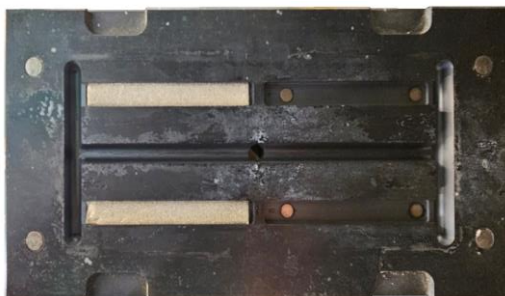
10. ábra A fémhab darabok behelyezése a szerszámüregbe
