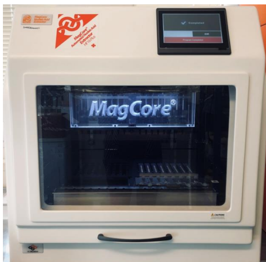
9. ábra. A laboratóriumban található MagCore® HF16 DNS izoláló robot, amellyel a DNS tisztítása történt.
