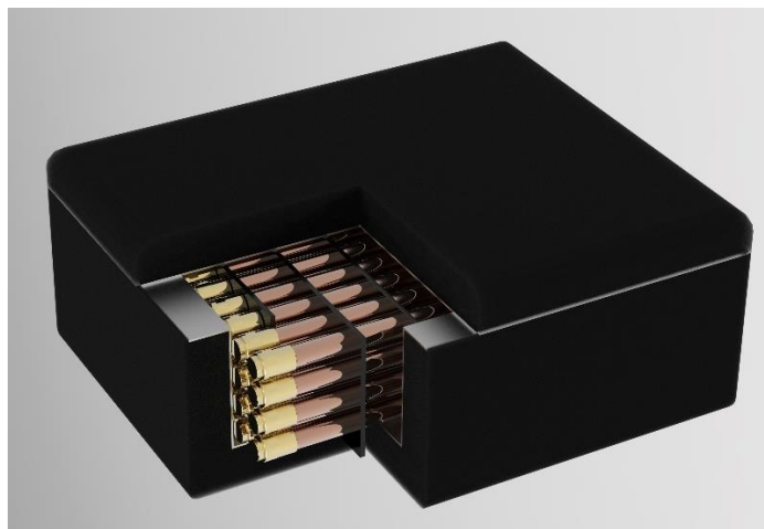
12. ábra A központi tartály és a belső hőcserélő modellje
