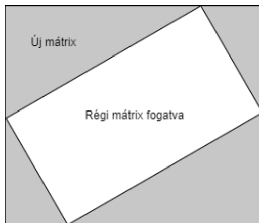
9. ábra: Az eredeti mátrix forgatva, és az általa meghatározható új mátrix. Az új mátrixot a forgatott mátrix négy sarka köré hozza létre a program.
