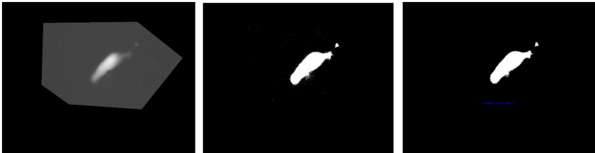
8. ábra: A kontrasztosítás lépései. A bal oldalon az eredeti kép látható, a középső kép a 0-1-es közötti küszöbérték meghatározása után készült, a jobb oldali kép pedig az első további kontrasztosítás eredményét mutatja. A program a további kontrasztosítások számát késsel ráírja a képre. Látható, hogy az első kontrasztosítás is igen jó eredményt ad, azonban jobban megnézve látszik a sejtest mellett a dudornál egy kis szóródás. A további kontrasztosítás ezt csökkentette.
