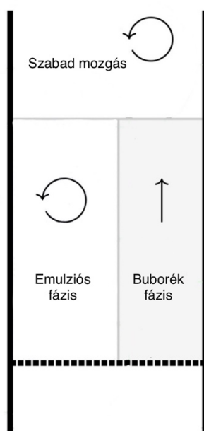
2.2.ábra: Szakaszos fluidágyas szárító kétfázisú modellje [40]
