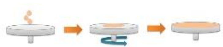
12. ábra: A forgótárcsás módszer lépései [37]
