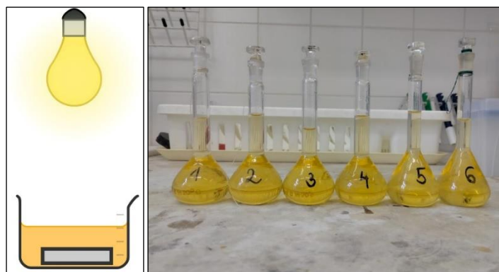
22. ábra: Színezékdegradációs mérés elvi elrendezése (bal) és a méréshez használt 10^{-5} M koncentrációjú metilnarancsszínezék-oldatok (jobb)
