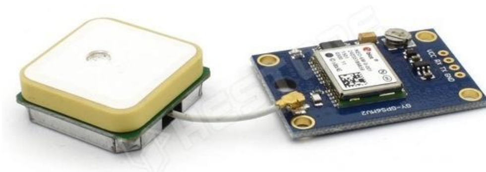
3.3. ábra: Ublox Neo 6M GY-GPS6MV2 modul
