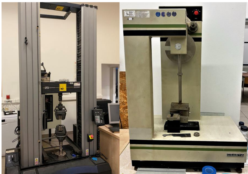
11. ábra Bal oldalon: Instron univerzális mérőberendezés, jobb oldalon: Ceast ingás ütőmű
