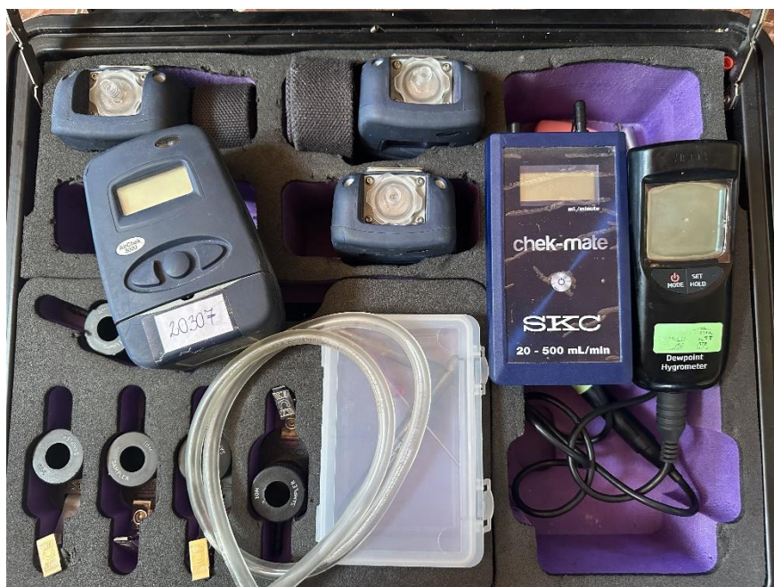
7. kép: Munkahelyi légtér mérésnél alkalmazott műszerek (Forrás: Saját készítés)
