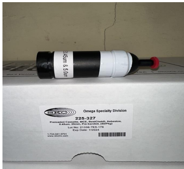
6. kép: Szálló rost méréséhez alkalmazott szűrő (Forrás: Saját készítés)
