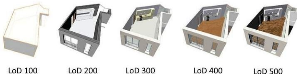
24. ábra Level of Detail (LoD) modell részletezettségi szintek 54
