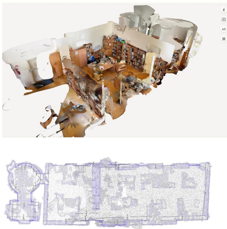
9. ábra LiDAR technológiával készített pontfelhő Polycam szoftver használatával (Pontfelhő perspektíva fent; Alaprajz lent) 17
