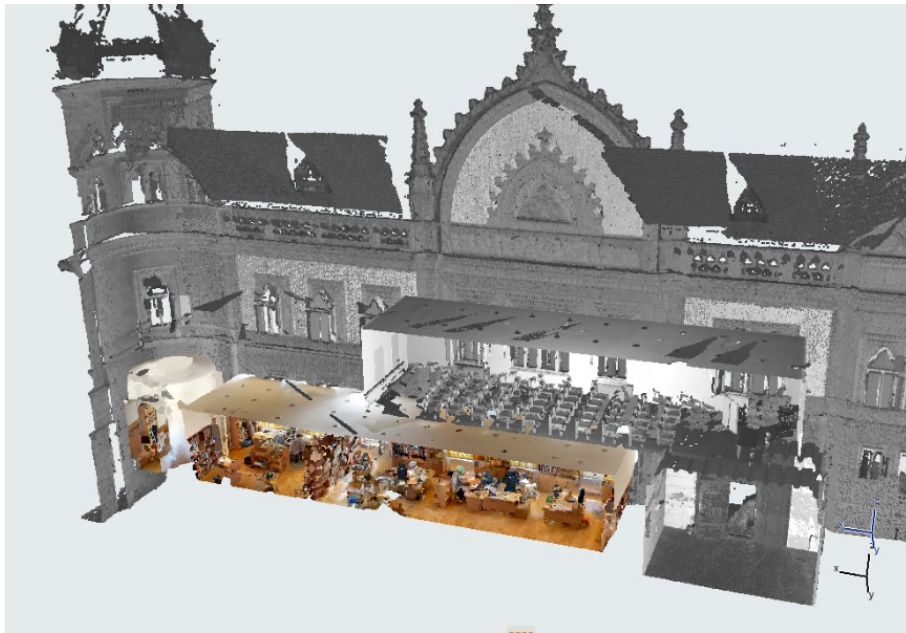
26. ábra Lézerskenneres és fotogrammetrikus pontfelhő összeillesztve 57
