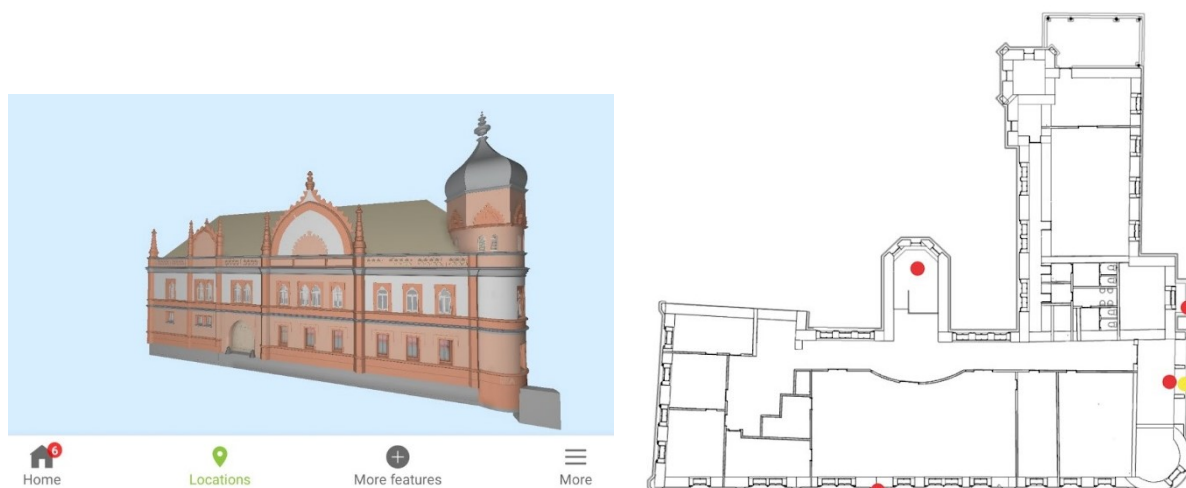
30. ábra Dalux szoftver kezelési platformja (HBIM modell perspektivikus ábrázolása balra; HBIM modell alaprajzán felvett hibajegyek jobbra) 64
