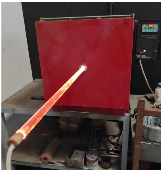
6. ábra Hőkezelő kemence az ajtaján keresztül behelyezett kvarccsővel és argon gáz bevezetéssel.
