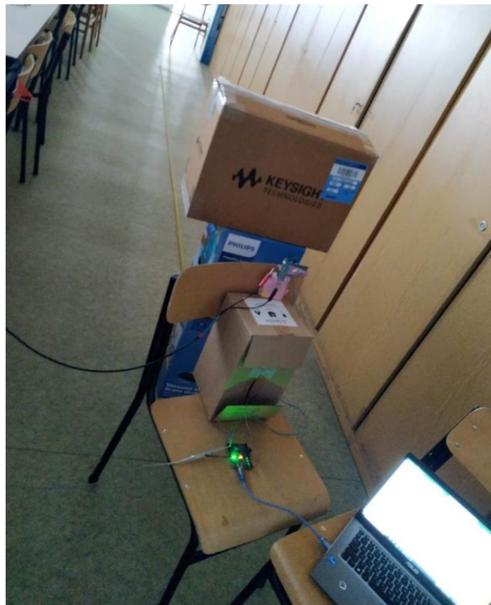
3.17. ábra A csillapítás mérésének a megvalósítása
