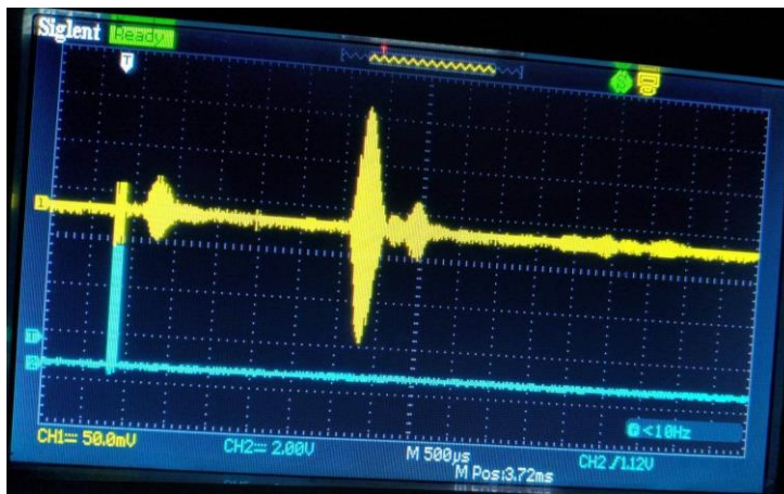
8.17. ábra Viszonylagos közel elhelyezkedő tárgyról reflektáló hullámok
