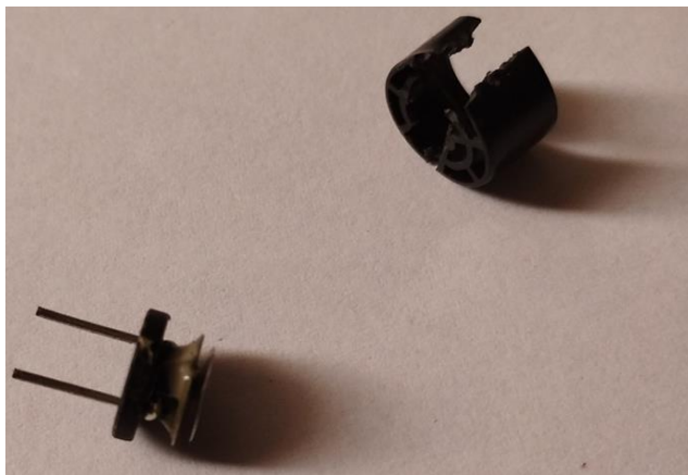
3.9. ábra Az általam használt eszköz belsőjéről készített fotó. Egy CTD40K1007R.
