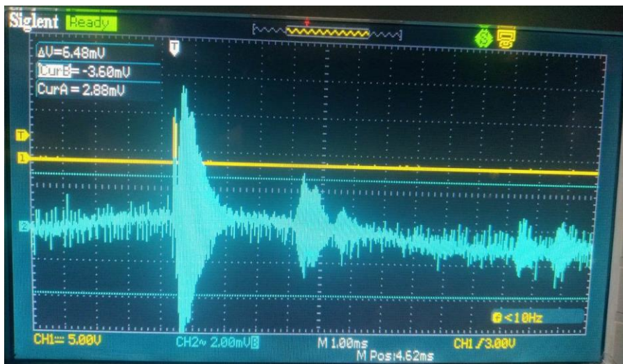
3.7. ábra Másodlagos reflexió első detektálása
