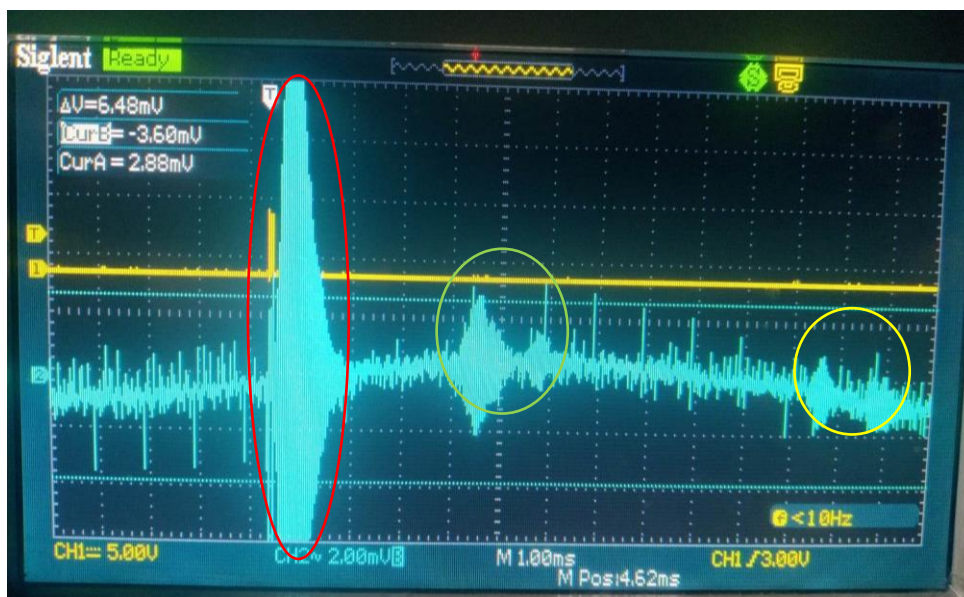
3.6. ábra Első reflexió mérése
