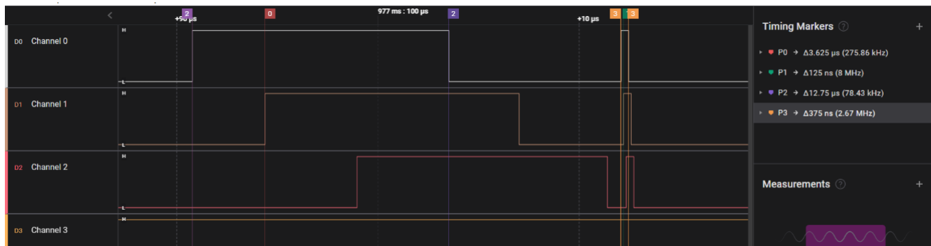
1.2. ábra C++ és assembly sebesség összemérő program eredménye
