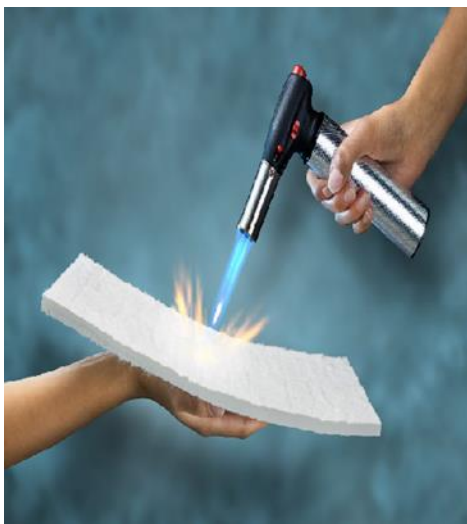
6.ábra: SLENTEX aerogél hőszigetelő paplan [19]
