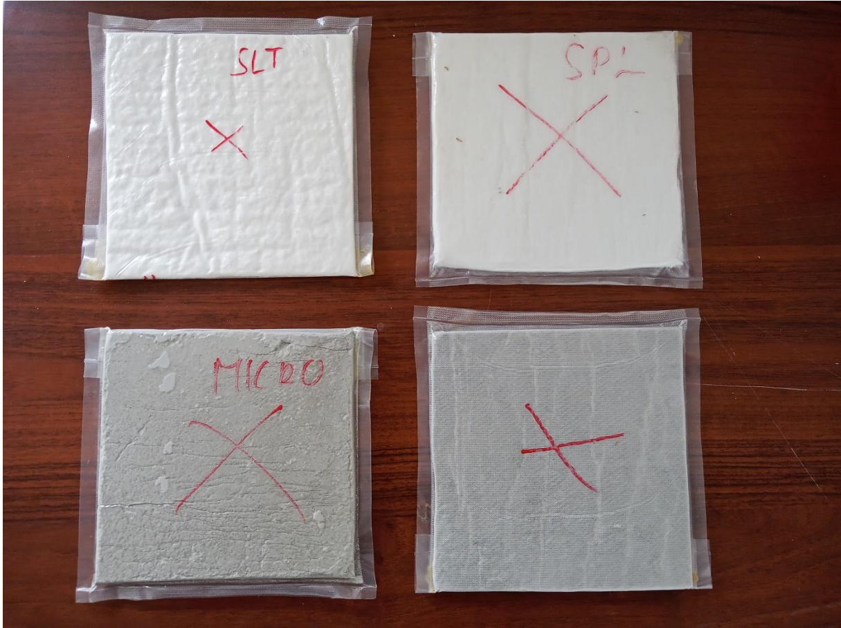
20. ábra: általam készített vákuumpanelek. Felső sor (balról jobbra): Slentex, Spaceloft, alsó sor (balról jobbra): Microtherm, Pyrogel [saját fénykép]
