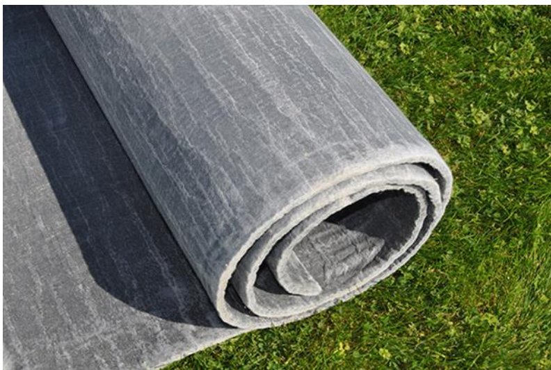
5.ábra: SPACELOFT aerogél hőszigetelő paplan [17]
