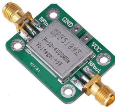
25. ábra: LNA 50-4000 MHz RF erősítő [57]
