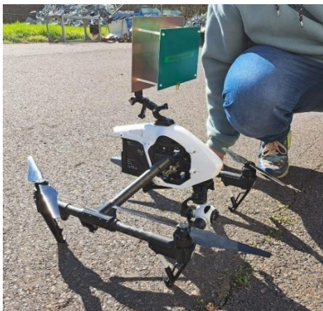
30. ábra: Drón-platformra felszerelt antenna és 3D nyomtatott alkatrészek, a vezetékes mérési eljárás során [szerző saját képe]
