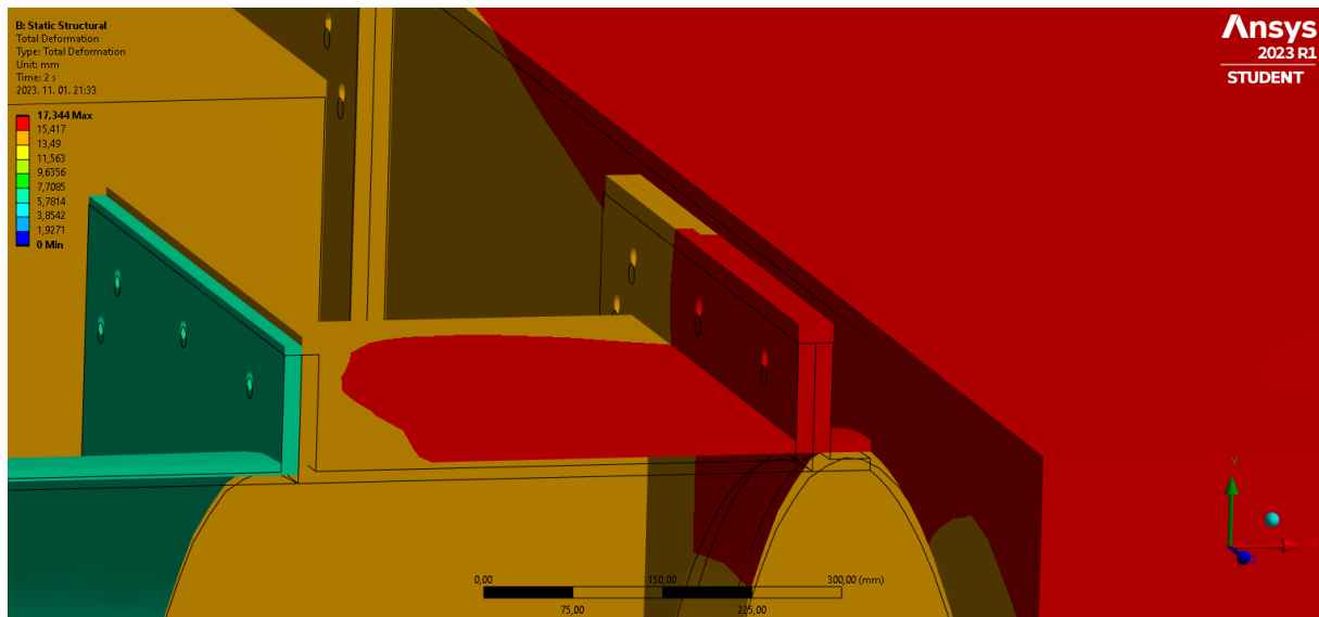
26. ábra elmozdulás szemléltetése az alakváltozás során
