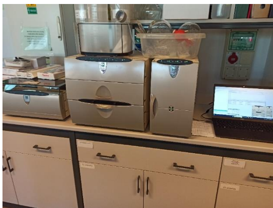
4. ábra: Dionex ICS- 3000 dual típusú nagynyomású folyadékkromatográf (HPLC) [saját fotó]
