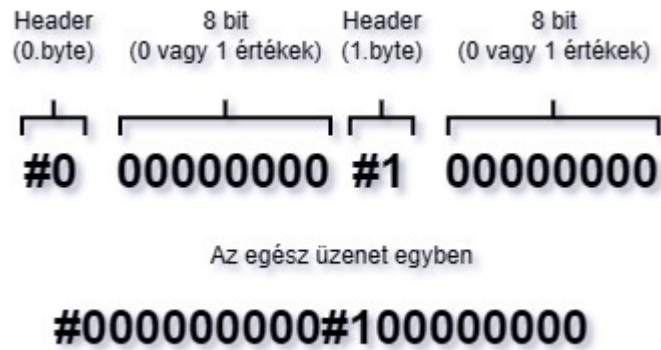
11. ábra: String üzenet felépítése (saját ábra)
