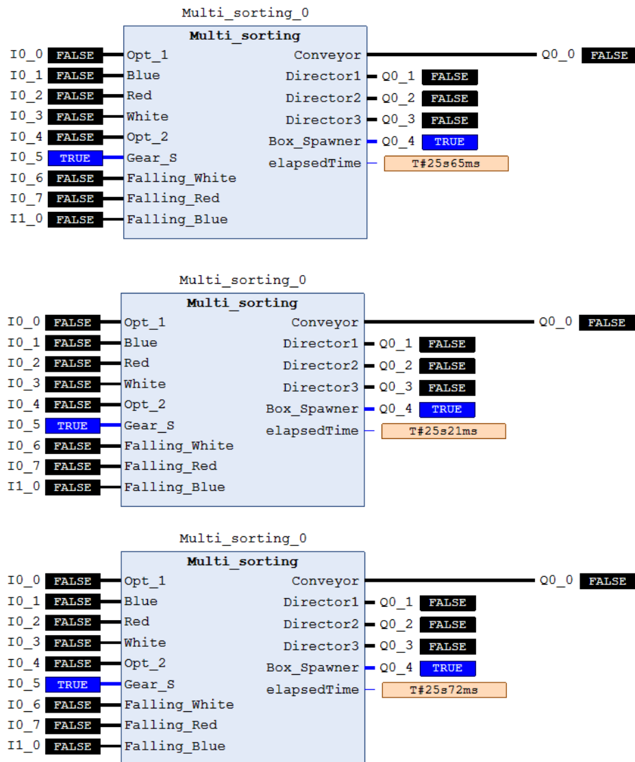
31. ábra: Válogató állomás programja [mérés 1, mérés 2, mérés 3] (saját)
