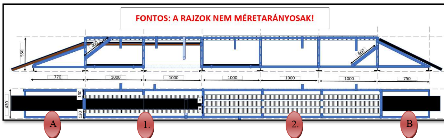
11. ábra Tervezett anyagtovábbító csomagolósor rajza - [10] alapján saját szerkesztés
