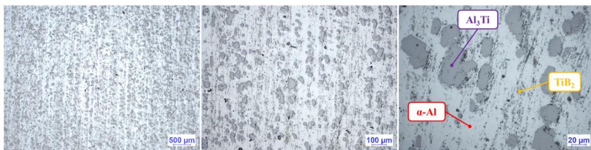
11. ábra: Al-5%Ti-1%B előötvözet szövetképének fénymikroszkópos felvételei (saját képek)
