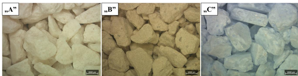
19. ábra: Kísérletek során alkalmazott kezelősók sztereomikroszkópos felvételei
