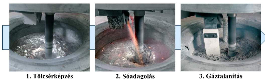
10. ábra: Gépi sóadagolással végzett rotoros gáztalanító olvadékkezelés lépései [62]
