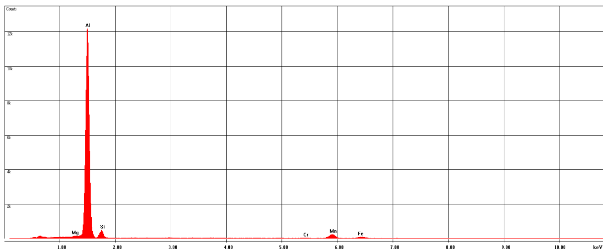
13. kiegészítő ábra Intermetallikus fázisok egyesülésének diffúziós mechanizmusának SEM felvételén 1-essel jelölt vegyületfázis röntgenspektruma
