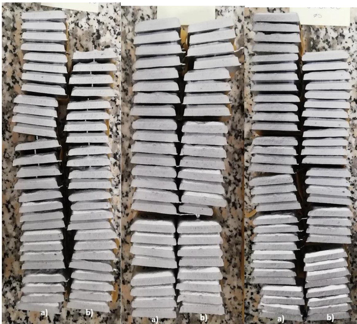
22. ábra Kizárólag nitrogén öblítéses tisztítási eljárás után vizsgált töretek
