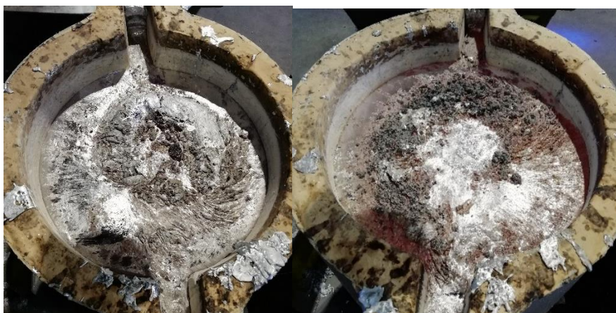
24. ábra Sózással végzett olvadéktisztítási kísérletek után képződött salak
