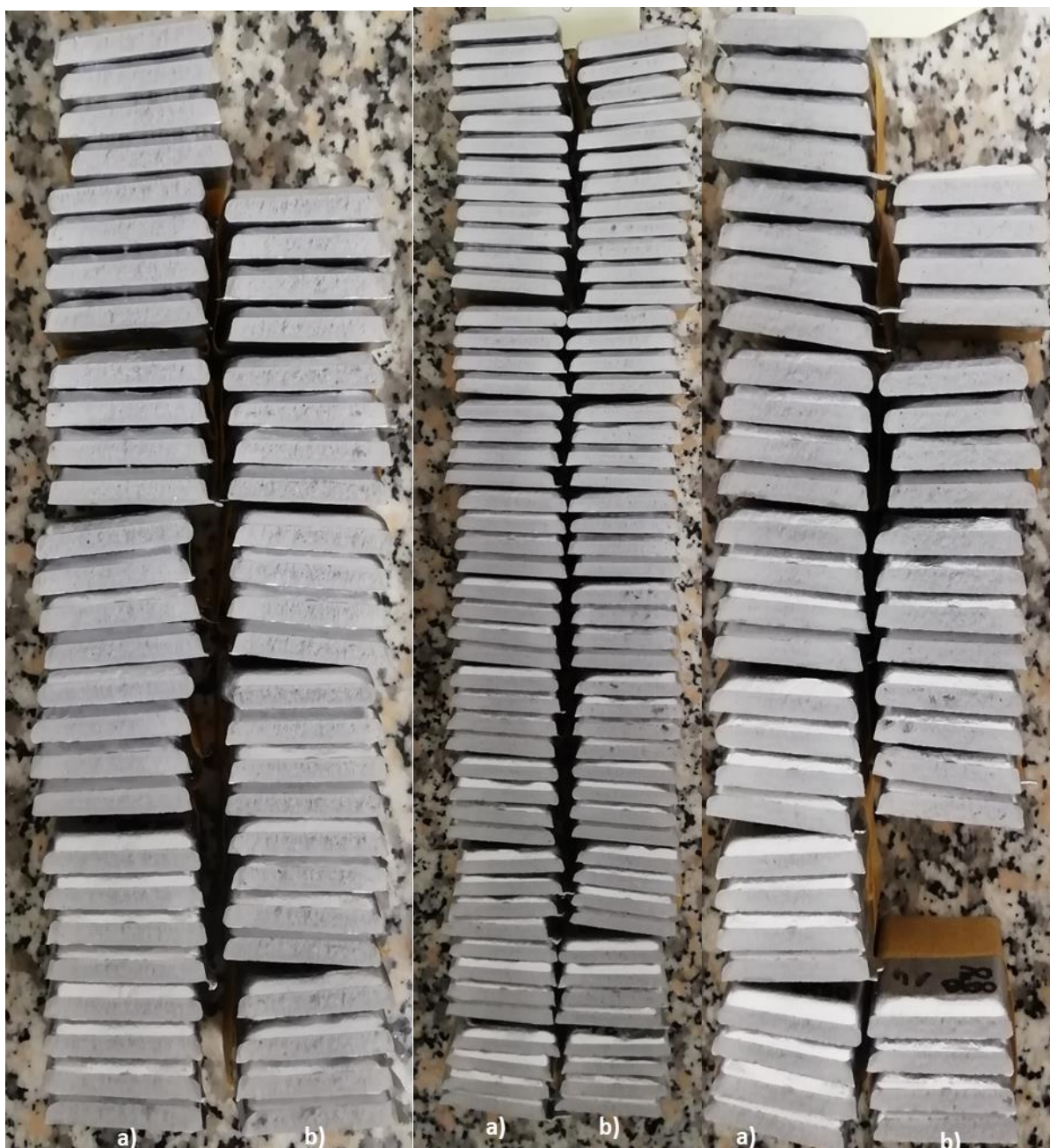
21. ábra Az olvadéktisztító só alkalmazásával vizsgált töretek
