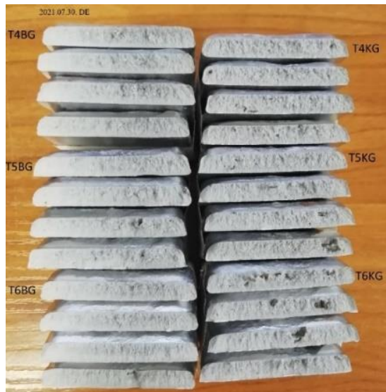
4. ábra A TBG minták (bal oszlop) és a TKG minták (jobb oszlop) töretfelülete
