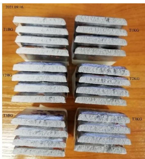
7. ábra A töretfelületek tisztasága az olvasztási hőmérséklet függvénye
