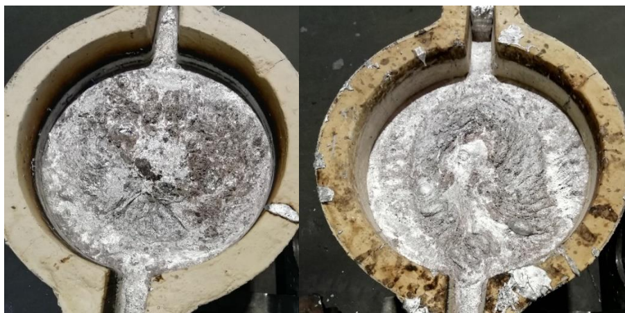
23. ábra Egybefüggő salak és oxidos hárták az olvadék felületén
