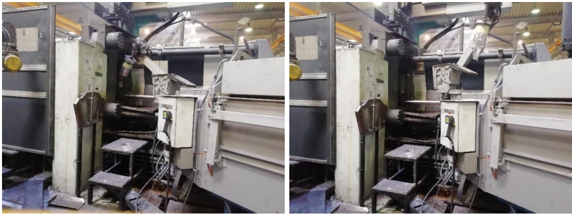
17. ábra A Silafont36 kísérleti öntésére alkalmazott, pipettás mechanizmussal működő FRECH 1050 típusú öntőgép
