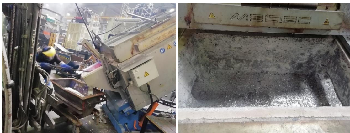
16. ábra A hűtőtartó kemencében végzett ötvözetváltás és a tiszta hűtőtartó tér
