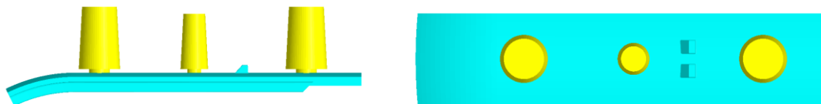
11. ábra A tápfejek pozíciója oldal és felülnézetben
