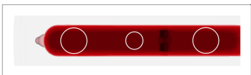
13. ábra A számított zsugorodások és az arra grafikusán pozicionált tápfejek helyzete és átmérője
