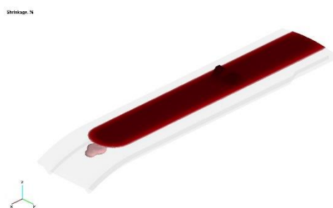
8. ábra Kialakuló fogyási üregek Fedlap oldal, áttetsző nézet
