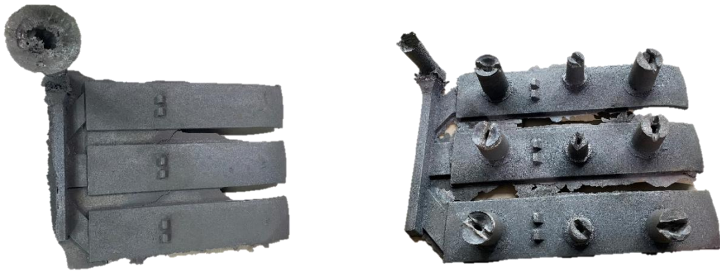
23. ábra Tápfej nélkül és tápfejjel öntött öntvénycsokrok
