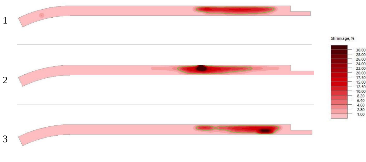
20. ábra Az egyes öntvények középvonali metszetén lévő zsugorodások
