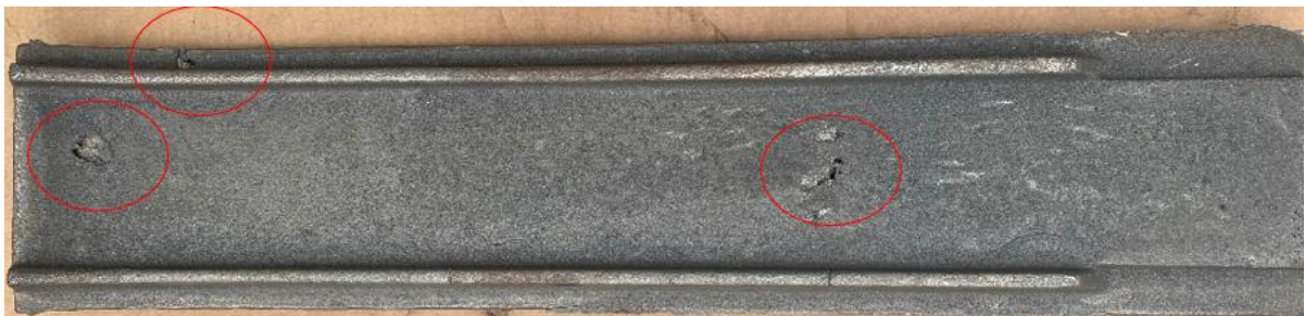
24. ábra Zsugorodási üregek a tápfej mentesen öntött darabon
