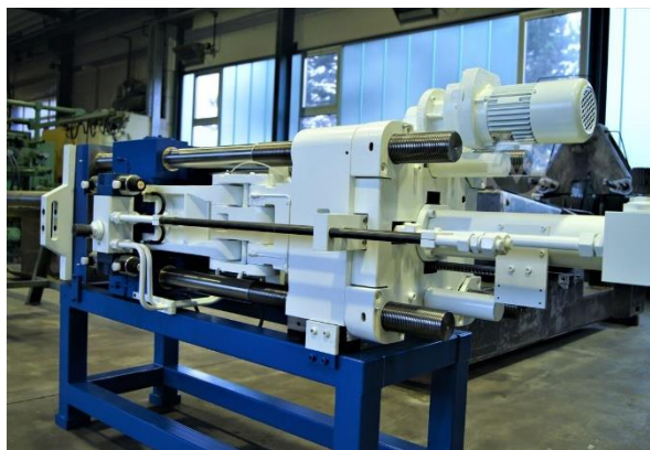
4. ábra Felújított DAW 63 FRECH öntőgép és üzemben lévő öntőgép
