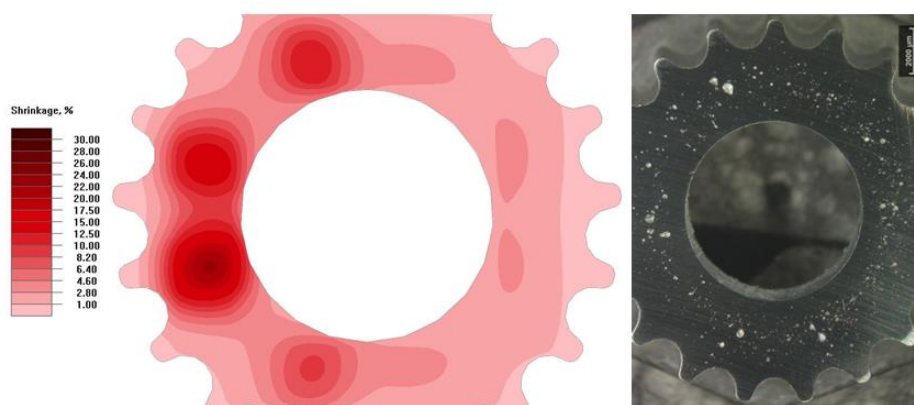
27. ábra Porozitás eloszlás, szimulált és valós metszeti kép
