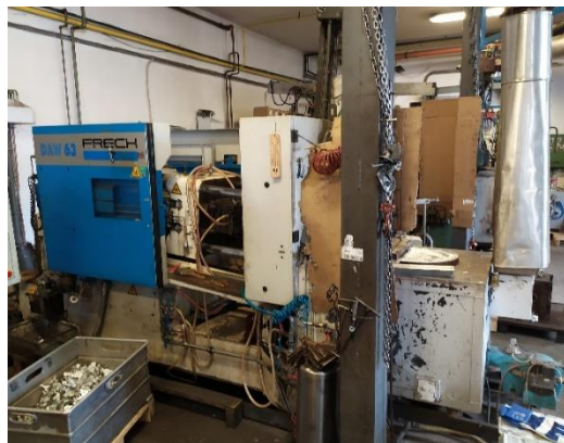
4. ábra Felújított DAW 63 FRECH öntőgép és üzemben lévő öntőgép
