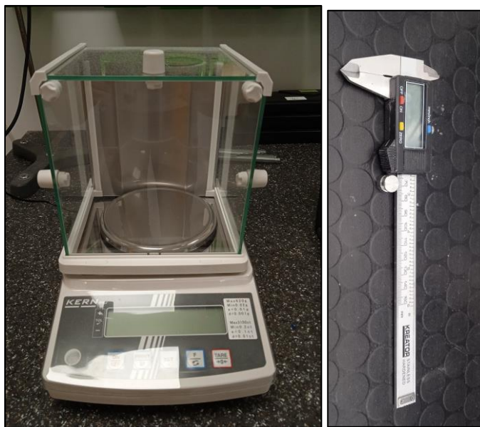
8. ábra: A látszólagos sűrűség és fizikai paraméterek meghatározásához használt Kern PNJ mérleg és Kreator digitális tolómérő
