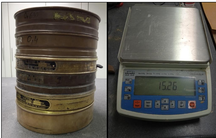
7. ábra: A szitáláshoz és szemcseméret-eloszlás meghatározásához felhasznált szitasor és táramérleg
