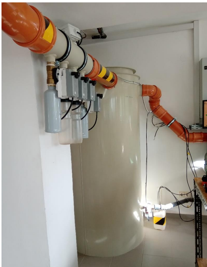
3.2. ábra. Automata mintavevő a kontroll- és zöldtető alatt (Készítette: Gáspár Bernadett 2023.11.07.)
