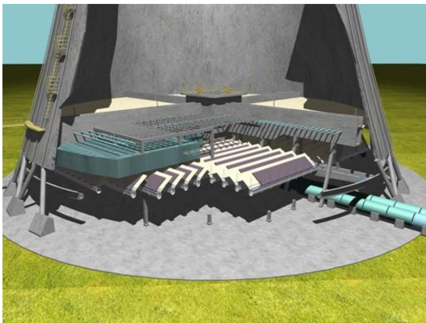
3. ábra: A természetes huzatú nedves hűtőtorony metszete (ou.edu, The University of Oklahoma, 2016)
