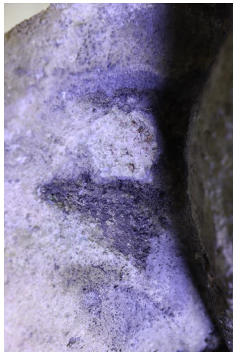
14. kép: (bal oldalon) Tisztítópróba - ammónium-citrátos és ammónium-karbonátos pakolás gipszkéreg eltávolítására (Gazdagréti Szentháromság-oszlop 1761)
