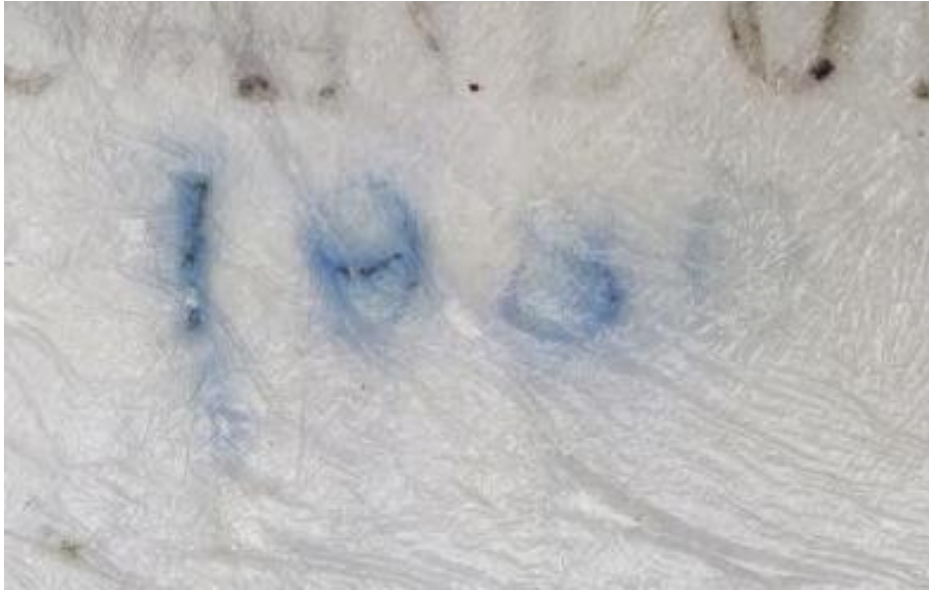
16. kép: Réztartalmú metál fólia ammónium-citrát pakolással ellátva
