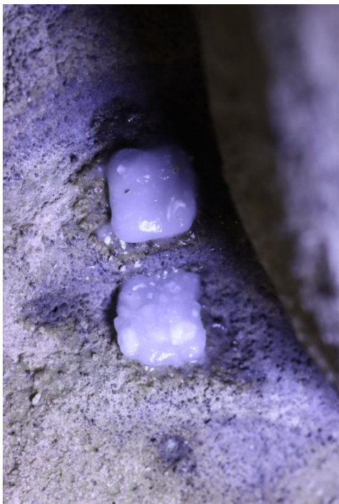
14. kép: (bal oldalon) Tisztítópróba - ammónium-citrátos és ammónium-karbonátos pakolás gipszkéreg eltávolítására (Gazdagréti Szentháromság-oszlop 1761)
