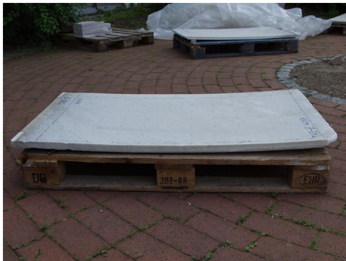
16.-17.. ábra: Helsinki, Finlandia-ház, torzult (deformált) burkoló lapok a homlokzaton.
