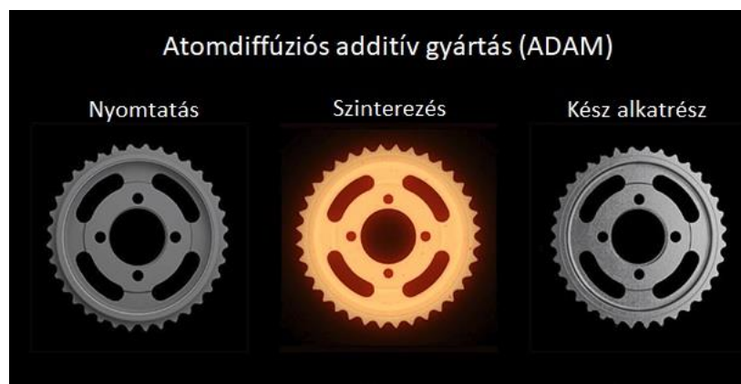
11. ábra: ADAM additív gyártás fázisai (Szerkesztette: Tenczel Martin Bence)
