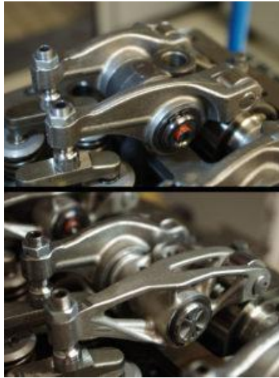
26. ábra: Felül hagyományos szelephiba, alul fém 3D nyomtatott szelephiba https://3dprint.com/161346/renault-3d-print-engine-components/ (Letöltve: 2023.11.07)
