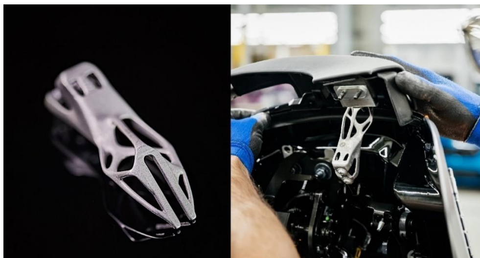
18. ábra: BMW i8 Roadster tetőmerevítő konzolja
