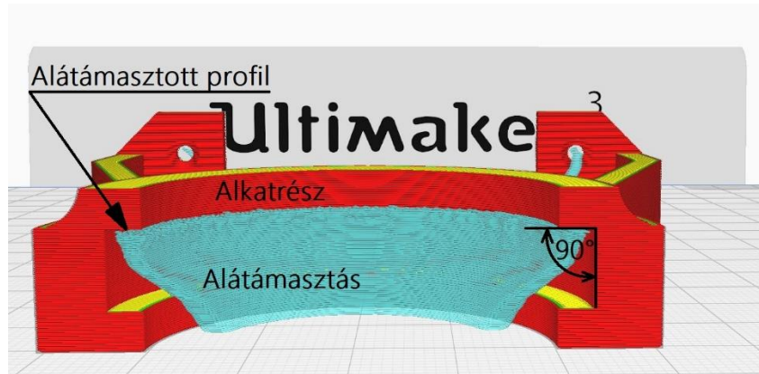
37. ábra: A bolygómű tartószerkezet jobb oldalának alátámasztás stratégiája (Készítette: Tenczel Martin Bence)
