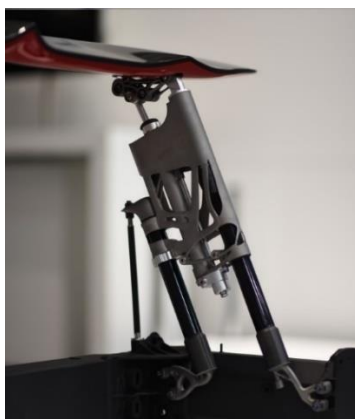
23. ábra: Fém 3D nyomtatott aktív spoilerkonzol
