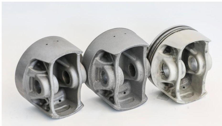
20. ábra: A Porsche GT2 RS 3D nyomtatott dugattyúinak gyártási fázisai https://media.porsche.com/mediakit/porsche-innovation/en/porsche-innovation/3d-printed-pistons (Letöltve: 2023.11.04)
