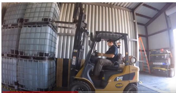
13. ábra: Targonca villája általi IBC lyukadás (saját szerkesztés 23 alapján)
