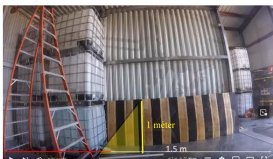
15. ábra: IBC sérülése 1 szint esetén, a csap vonalában (saját szerkesztés 25 alapján)
