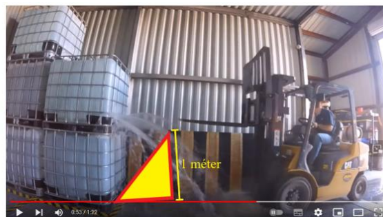
14. ábra: IBC sérülése a csapnál és targonca általi lyukadás (saját szerkesztés 24 alapján)
