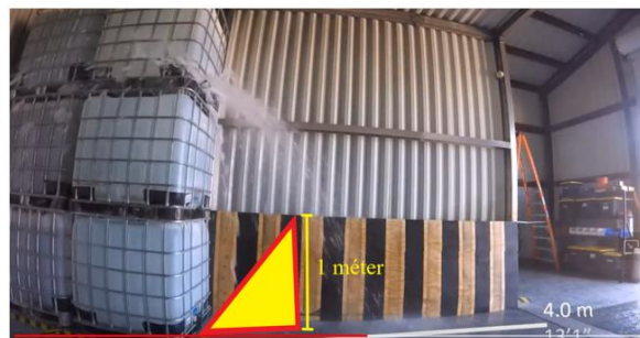
13. ábra: Targonca villája általi IBC lyukadás (saját szerkesztés 23 alapján)
