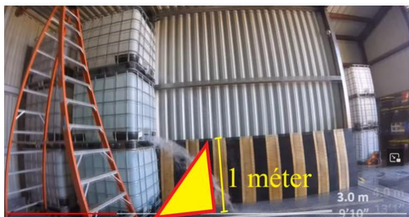
14. ábra: IBC sérülése a csapnál és targonca általi lyukadás (saját szerkesztés 24 alapján)
